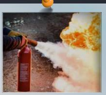
تستخدم في إطفاء معظم أنواع الحرائق في بدايتها و لها فعالية قوية في إطفاء حرائق التحميزات الكهربائية
